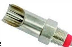
1038 Поилка-ниппель для свиноматок и отделочников, из нержавеющей стали. Резьба 1/2", корпус 3/4", ниппельная поилка диаметром 3/4" дюйма, штифт диаметром 8мм.
