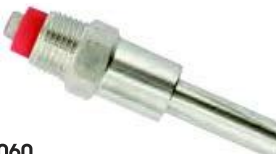
1060 Поилка-ниппель 1/2" для отъемщиков, откормщиков, отделочников, из нержавеющей стали. Шестигранник 22мм, штифт 12мм, длина корпуса 46мм, длина наружного штифта 20мм.
