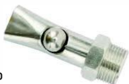
1026 Поилка-ниппель 1/2" для поросят весом до 35кг. Корпус из нержавеющей стали с шариковой насадкой. Длина 63мм.
