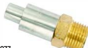
1077 Поилка-ниппель для отъемщиков, откормщиков, отделочников, из нержавеющей стали. Латунная резьба 1/2, шестигранник 21мм, труба Ф21, штифт Ф12*15мм.
