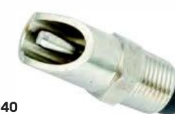
1040 Поилка-ниппель для поросят, из нержавеющей стали. Резьба 1/2", шестигранник 22мм, штифт 5мм.
