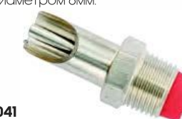
1041 Поилка-ниппель для поросят, из нержавеющей стали. Резьба 1/2", шестигранник 22мм, штифт 6мм.
