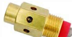
1085 Поилка-распылитель 1/2" из латуни. Шестигранник корпуса 22мм, длина 47мм, нажимная кнопка 17мм, 4,5л/мин. С отверстиями.
