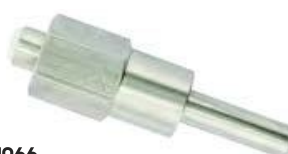
1066 Поилка-ниппель 1/2" для свиноматок, из нержавеющей стали. Шестигранник 24мм, штифт 11мм, длина 94мм. Производительность до 12л/мин, расход до 8л/мин.
