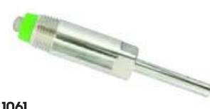
1061 Поилка-ниппель 1/2" для отъемщиков, откормщиков, отделочников, из нержавеющей стали. Резьба 1/2 дюйма, длина 106мм, штифт 8мм.
