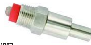
1057 Поилка-ниппель 1/2" для откормщиков, свиноматок на откорме, из нержавеющей стали. Шестигранник 22мм, штифт 12мм, длина корпуса 46мм, длина наружного штифта 20мм.
