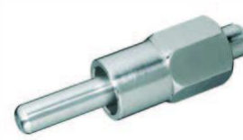
10092-13 Поилка ниппельная 1/2", для свиноматок, производительность 12л/мин, с 1/2" внутр. резьбой
