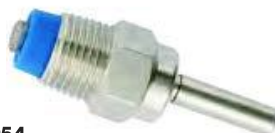
1054 Поилка-ниппель поросят, из нержавеющей стали диаметром 1/2". Шестигранник 22мм, штифт 8мм, длина 60мм.
