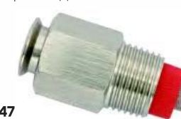
1043 Поилка-ниппель для свиноматок и отделочников, из нержавеющей стали. Резьба 3/4" дюйма, корпус 3/4" дюйма. Шестигранник 27мм, штифт 8мм, длина 80мм.
