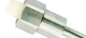
1065 Поилка-ниппель для отъемщиков, откормщиков, отделочников, из нержавеющей стали. Внутренняя резьба 1/2", шестигранник 24мм, 70мм длина, штифт 8мм.
