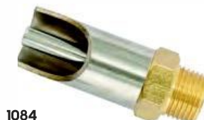
1084 Поилка-ниппель свиноматок и отделочников. Латунная резьба 1/2", шестигранник 27мм, труба Ф25мм, штифт Ф8мм.
