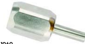
1069 Поилка-ниппель для отъемщиков, откормщиков, отделочников, из нержавеющей стали. Внутренняя резьба 1/2 дюйма, длина штифта 84мм.
