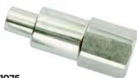
1075 Поилка-ниппель для поросят, из нержавеющей стали. Внутренняя резьба 3/8", шестигранник 22мм, длина 61мм, штифт 12мм.
