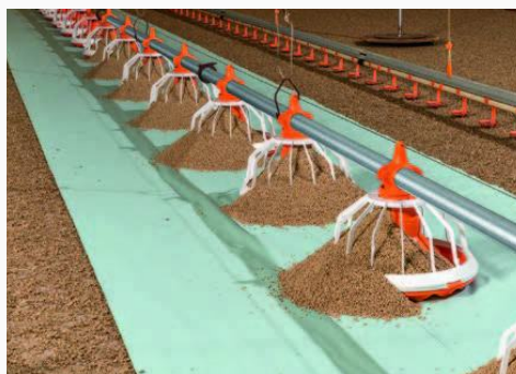
Специально разработанная кормушка FLUXX 330 может быть полностью заполнена для идеального приготовления цыплят
